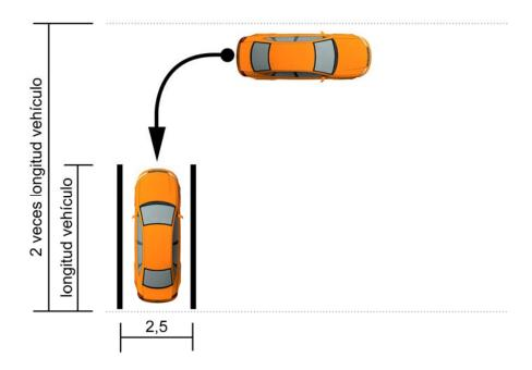
Estacionamiento seguro para cargar o descargar en una rampa o plataforma de carga o instalación similar
