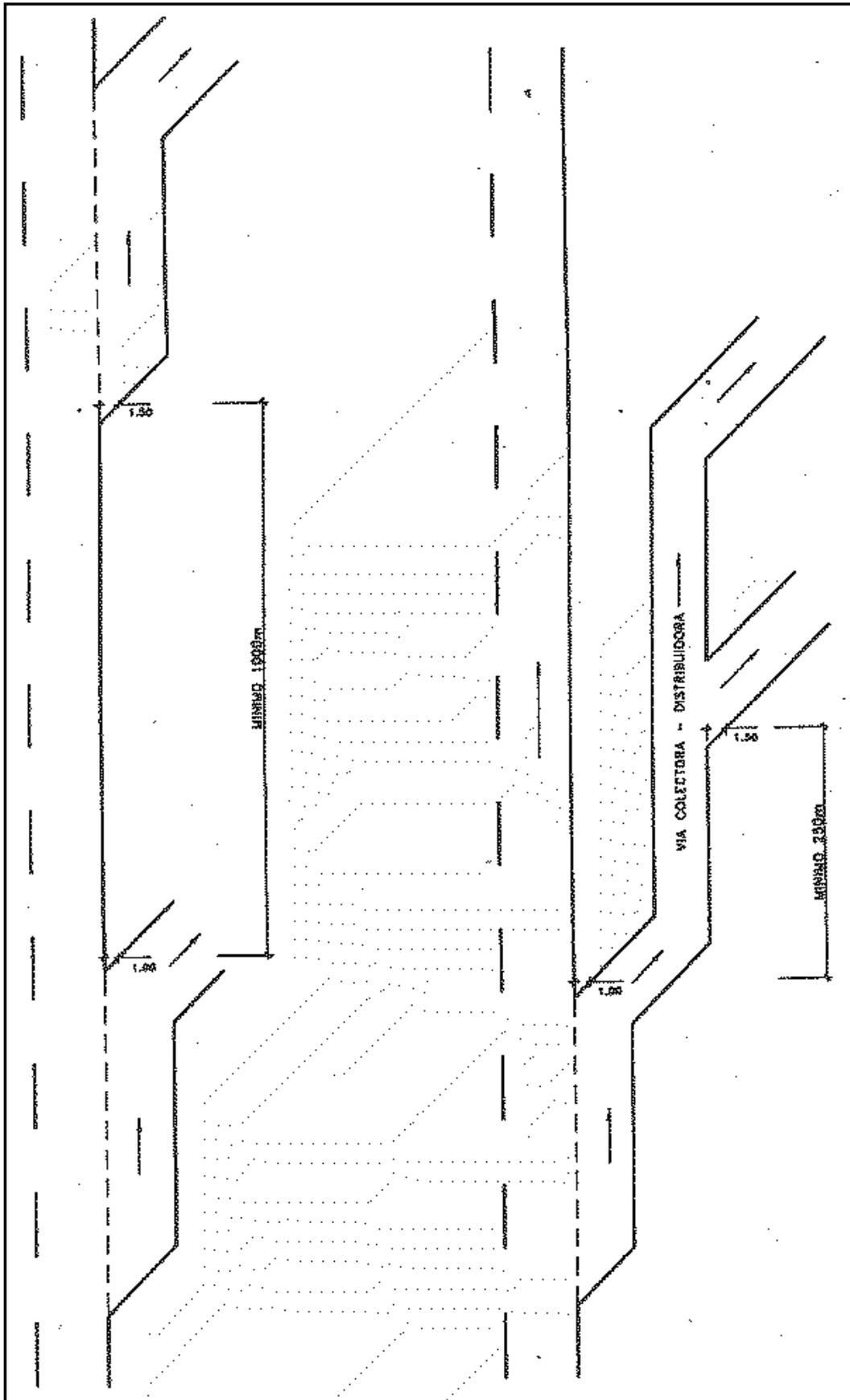
**FIGURA 3 CONEXIONES ESPECÍFICAS EN AUTOVÍAS**
