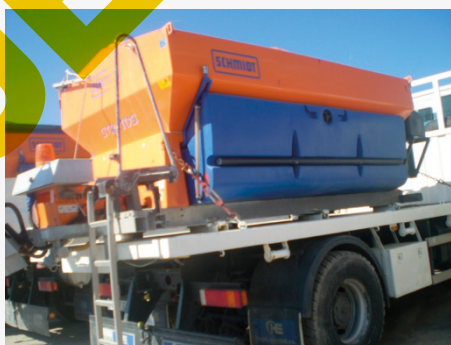
Foto: Escala de acceso al depósito.
