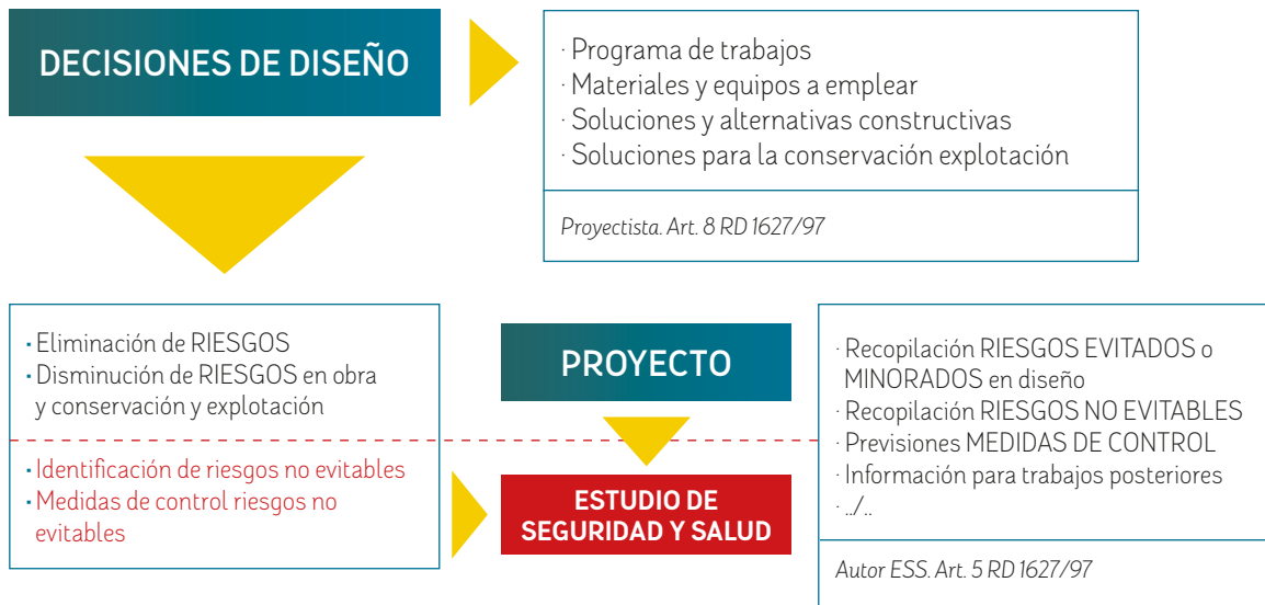
Figura 1.- Proceso de integración de la prevención a seguir durante la elaboración del proyecto.
