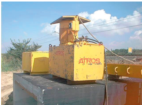
Fotos 2 y 3. Central hidráulica y elementos distanciadores entre gatos y muro de reacción.
