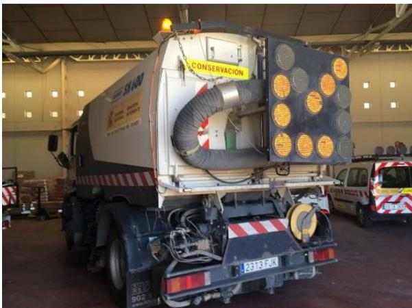
Figura 1. Comprobación del funcionamiento de la señalización luminosa de los vehículos.
